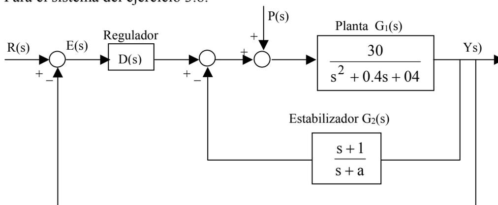
Considerando  $D(s) = 1$ , calcular el rango de valores del polo del estabilizador 'a' para los que el sistema total es estable.
